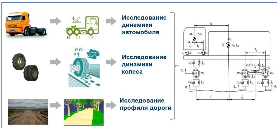
Структура модели движения автомобиля по дороге
